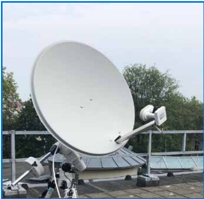
▲ De zonnenuisschotel gebouwd door Sonnenborgh staat op een equatoriale montering waarmee de telescoop over één as gedraaid hoeft te worden om de zon te kunnen volgen. Foto: Sonnenborgh, Utrecht.
