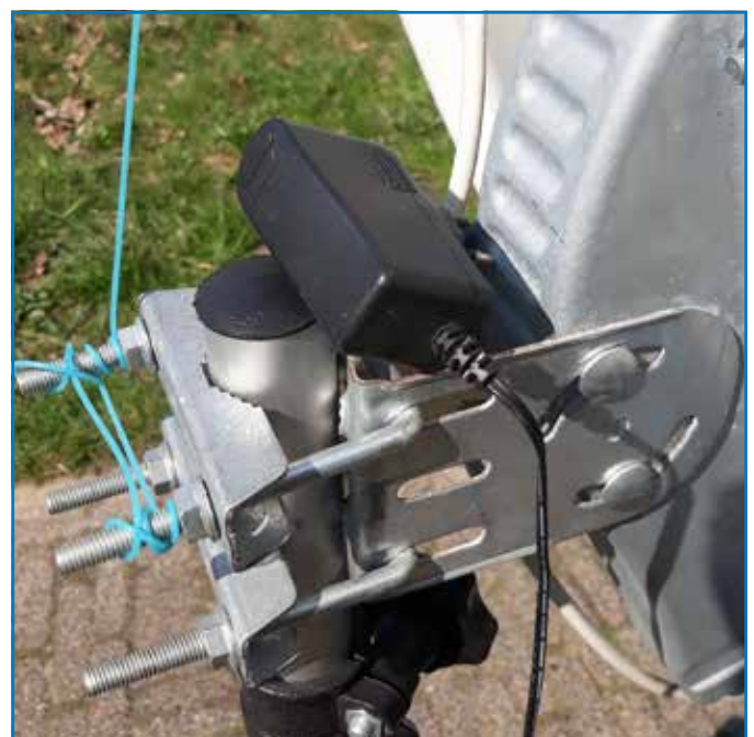
▲ De elevatie-afstelling werkt met de rail vol inkepingen. Op de klem ligt de netvoedingadapter, klaar voor gebruik. Foto: Andries Boone, Sterrenwacht Midden-Nederland.
