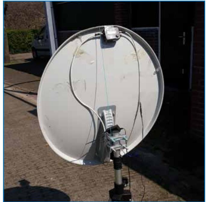
▲ De zonneruis wordt afgelezen op de signaalmetr die aan de bovenzijde is gemonteerd. Foto: Andries Boone, Sterrenwacht Midden-Nederland.
